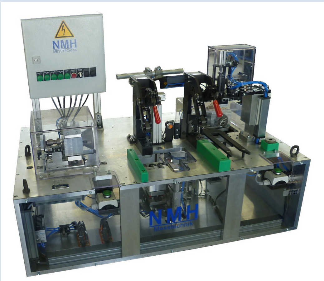
Abb. 1: Dimensionskontrolle Abgaswärmetauscher, Gesamtansicht
