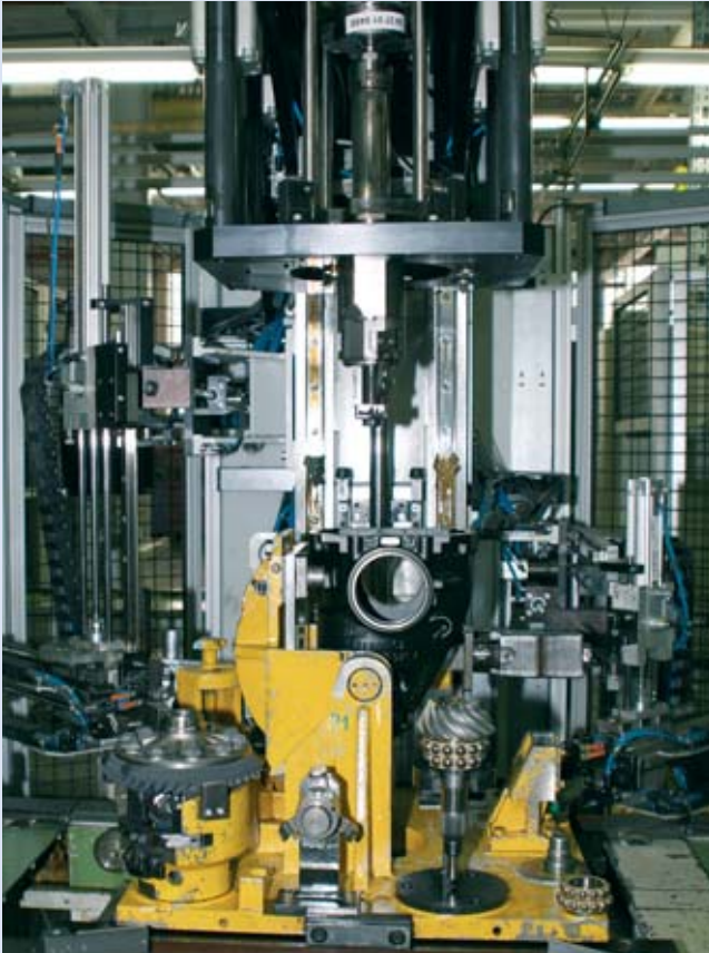
Abb. 4: AKR-Lageraußenringe in Gehäuse einpressen
