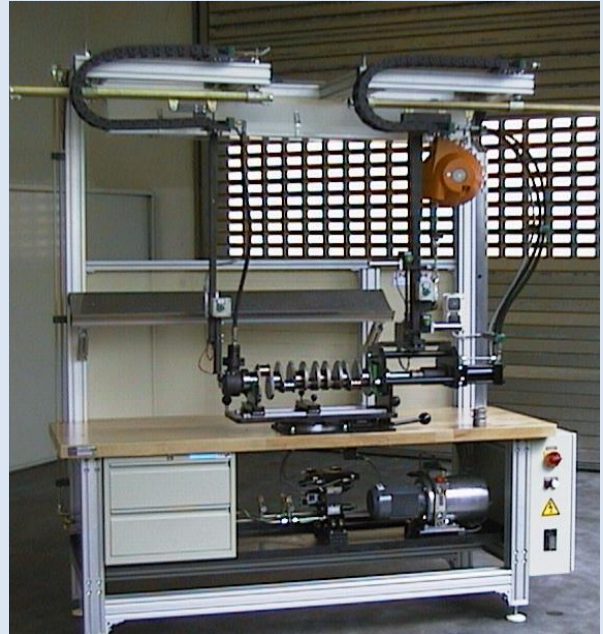
Abb. 1: Arbeitstisch für Kurbelwellenmontage
