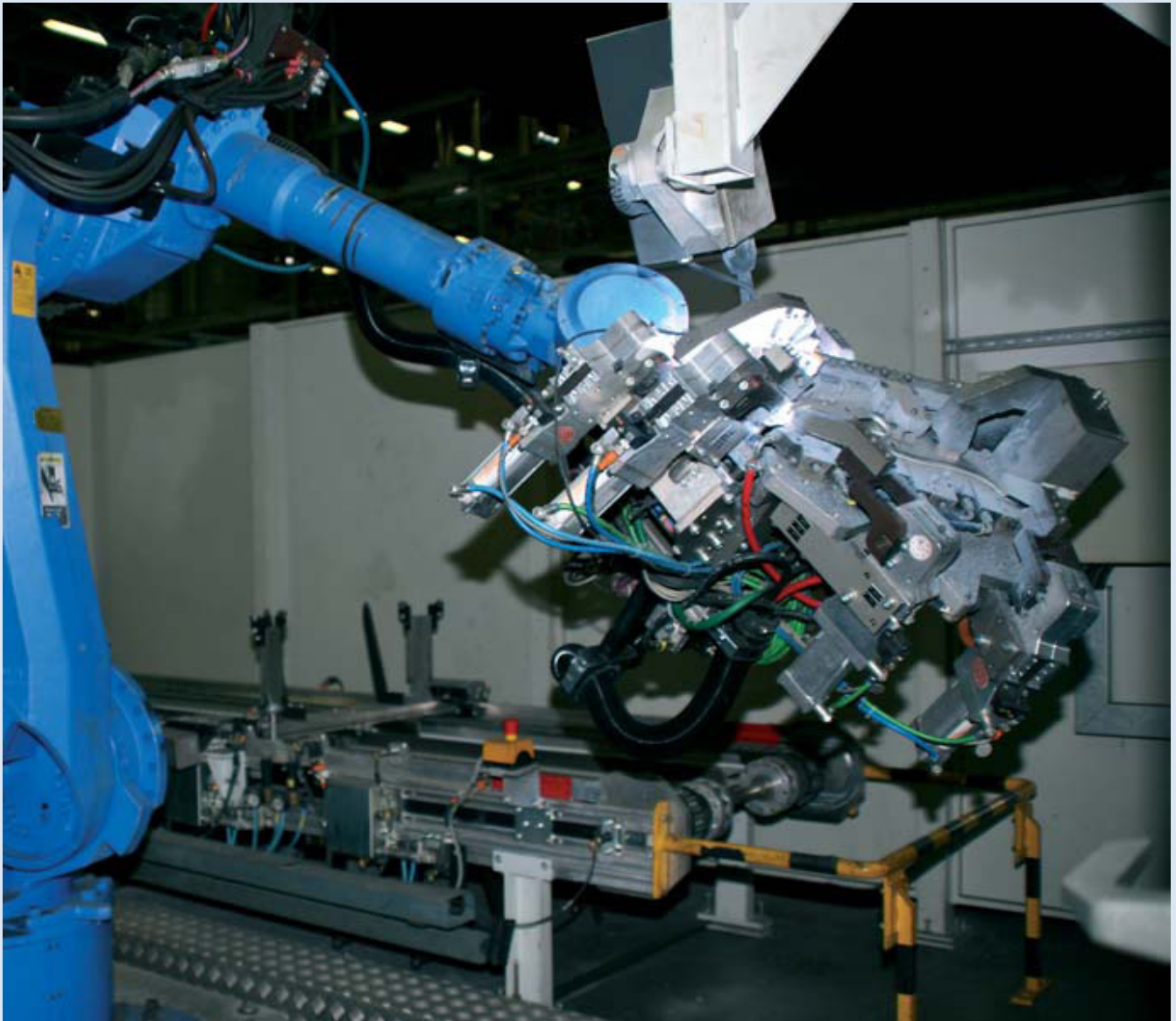
Abb.1: Robotergreifer als Flachdraht-Schweißvorrichtung
