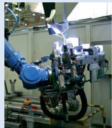
Abb.7: Roboter Greifvorrichtung für das Flachdrahtschweißen
