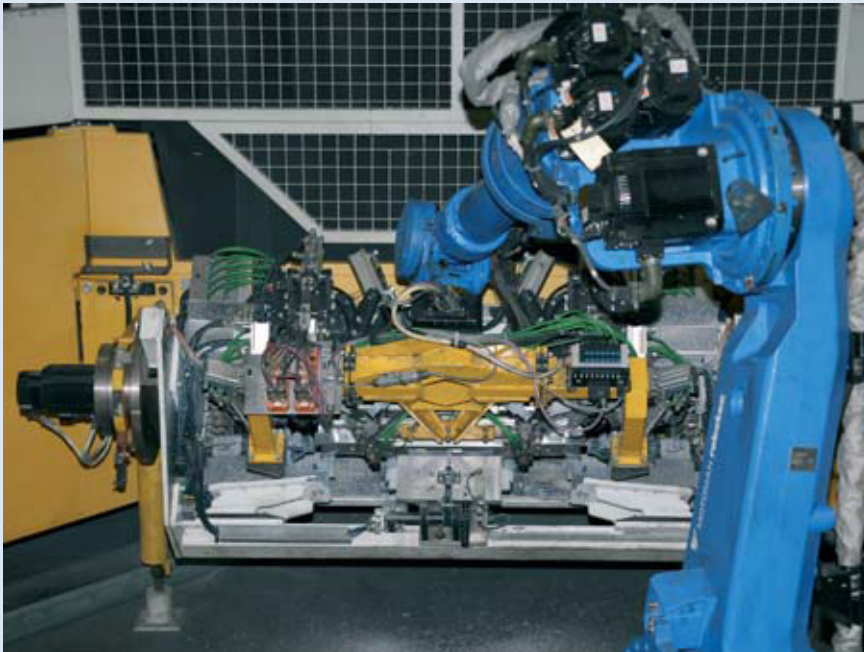
Abb.8: Greifer legt Bauteile in die schwenkbare Roboterschweißvorrichtung
