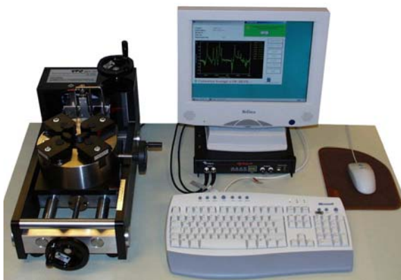
Abbildung 3: links: Beispiel für einen Versuchsaufbau zur Eigenfrequenzermittlung; Automatisches Messsystem zur Eigenfrequenzmessung
