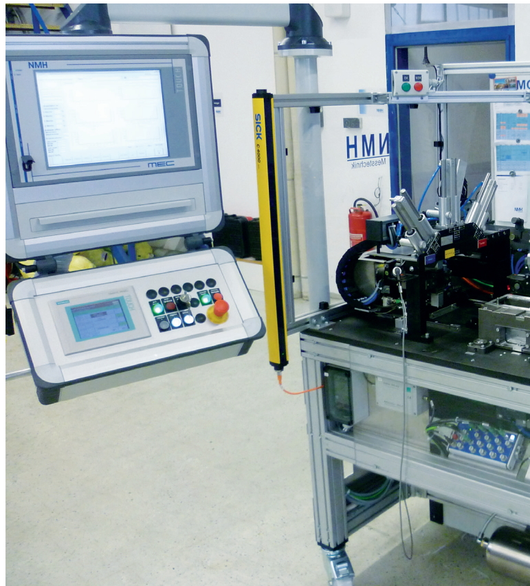
>> Messanlage zum prüfen von Schaltauslegern im NKW Bereich
