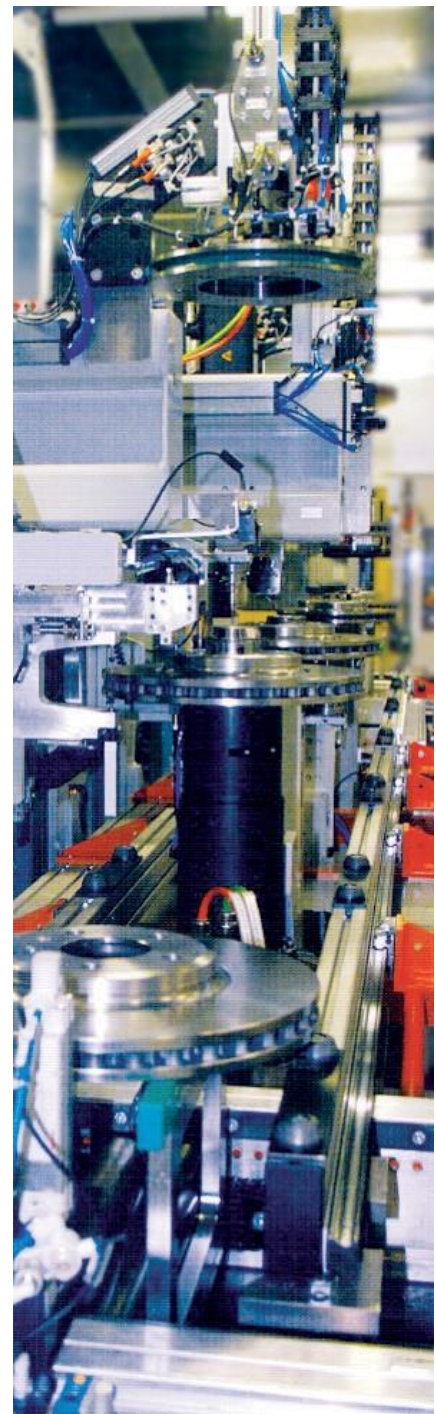
>> Bremsscheibenvermessung, Rissprüfung und Kennzeichnung
