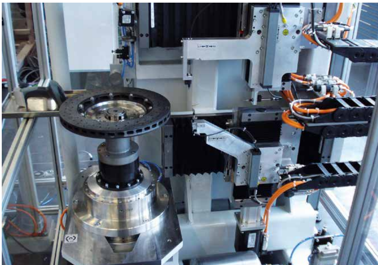
>> Halbautomat zum Prüfen von Carbon Bremscheiben und Sonderbremscheiben
